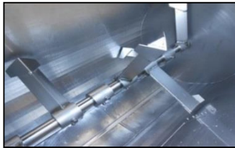
生ゴミ処理機の処理槽
